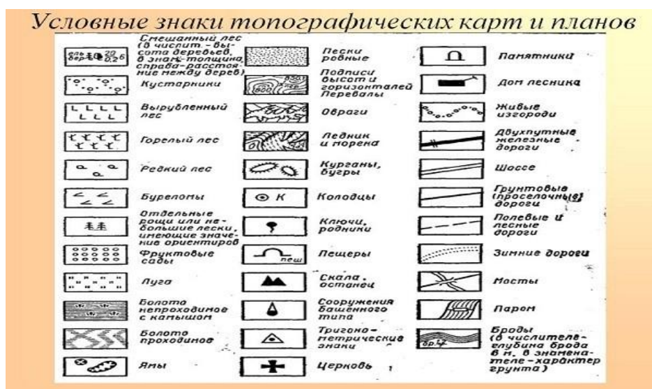
Рис. 1. Условные знаки плана местности и топографических карт
